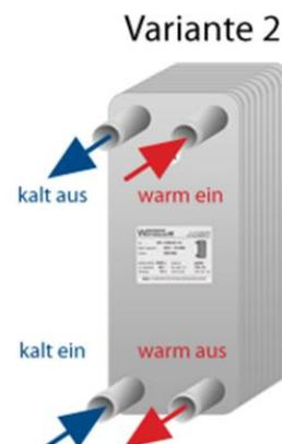
**Achtung:** Rohrleitungen sind so zu verlegen, dass weder Schwingungen, Spannungen, Stöße oder Pulsationen den Wärmetauscher beaufschlagen. Die Lebensdauer der Wärmetauscher wird durch falsche bzw. ungenügende Regeltechnik stark verkürzt. Hier einige Faktoren, die sich nachteilig auf die Lebensdauer auswirken und die zu vermeiden sind:
